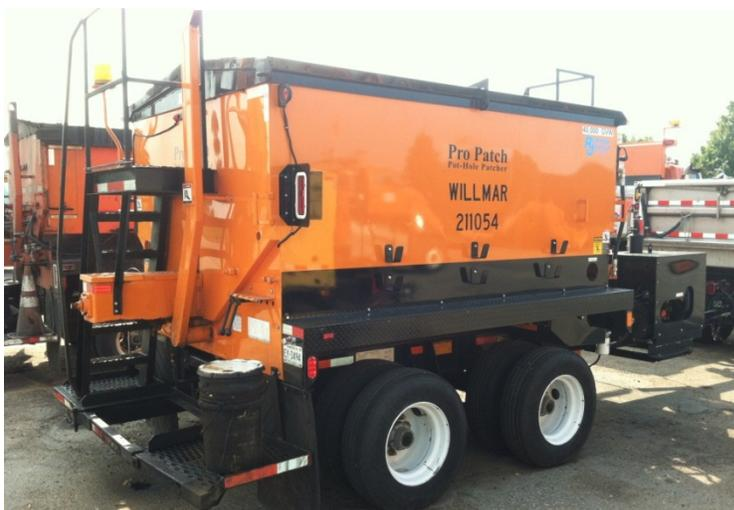
FIGURE 9: HEATED BITUMINOUS HOPPER
